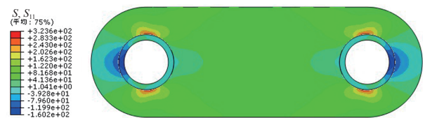
图7 单向拉伸应力分布云图
