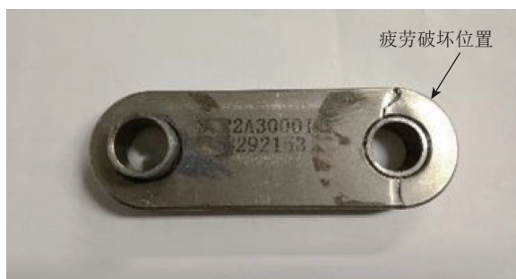
图 16 试验件疲劳破坏形式 Fig.16 Fatigue failureform of test specimen
