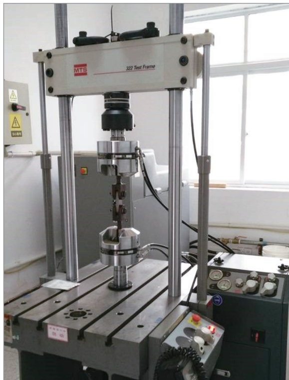
图 15 试验装夹方式 Fig.15 Test fixing method
